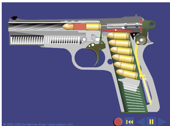
Figur 10.1 Halvautomatisk pistol, umid- delbart efter at patronen er affyret, og pro- jektilet er på vej ud i løbet, drevet af trykket fra krudtladningen.
